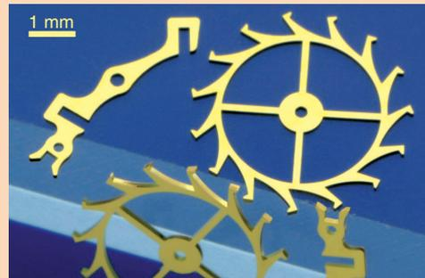
*Anker und Zahnrad für mechanische Uhrwerke werden mit dem LIGA-Verfahren so präzise hergestellt, dass keine Schmierung mehr erforderlich ist.*
