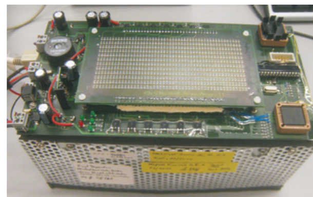
Prototyp des mikrofluidischen Brailledisplays. Gezeigt ist eine Steuerplatte mit insgesamt 588 individuell adressierbaren Heizwiderständen, auf der sich 588 einzelne Aktoren für einzelne Braillepunkte aufbauen lassen.
