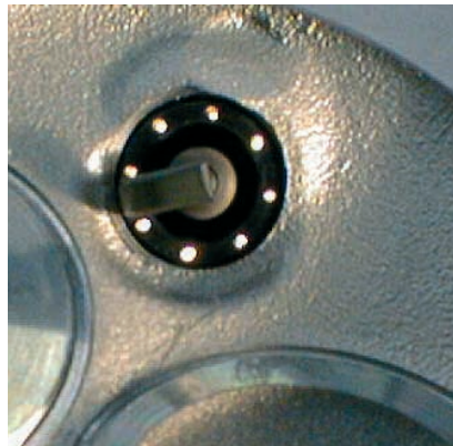
Lichtleiter integriert in die Zündkerze
