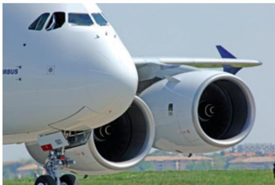
A380 mit dem Trent 900 Triebwerk
