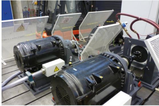
Kennfeldermittlung einer wassergekühlten Traktionsmaschine auf dem Antriebssystemprüfstand
