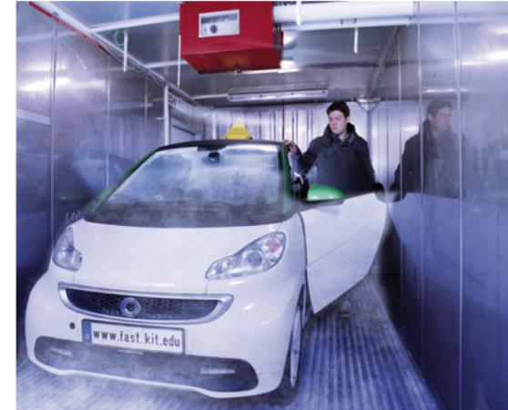
Versuchsfahrzeug im Prüfraum bei Simulation winterlicher Umgebungsbedingungen
