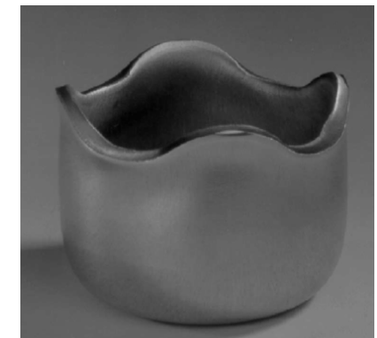
Tiefziehen eines Napfes
