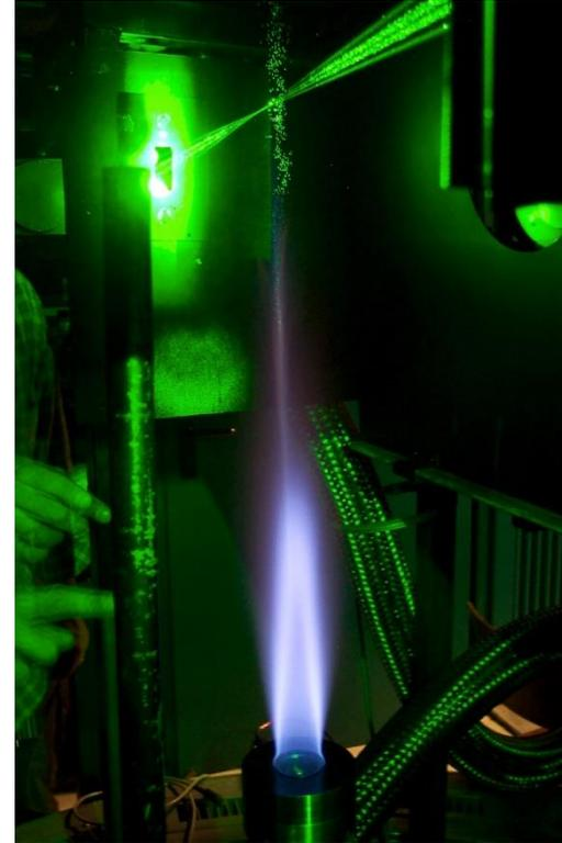
Laser-Diagnostik an einer Erdgasflamme, Quelle: ITT
