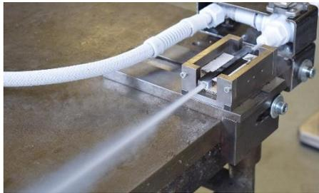
Kühlung mit flüssigem Stickstoff bei der Zerspangung von Titan
