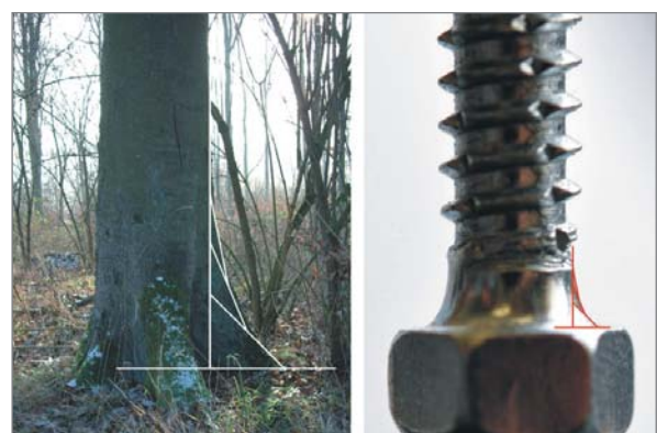
Einfache graphische Kerbformoptimierung nach dem Vorbild der Natur zur Reduzierung der Kerbspannung
