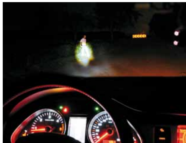
Eine potentielle Gefahrenstelle im Verkehrsbereich wird durch das intelligente Lichtsystem besonders beleuchtet und ist somit für den Fahrzeughführer früher erkennbar. Foto: Hörter
