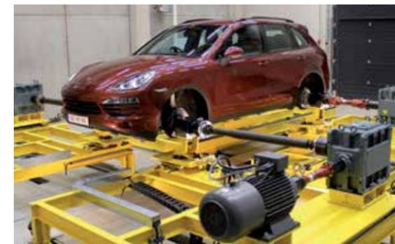
Anwendungsbeispiel für Vehicle-in-the-Loop. Untersucht wird das Gesamtfahrzeug, der Reifen-Fahrbahn-Kontakt und der Straßenverlauf sind in der Simulation abgebildet.
