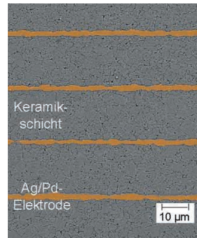
Gefüge eines piezokeramischen Vielschichtaktors zur Steuerung der Benzindirekteinspritzung.
