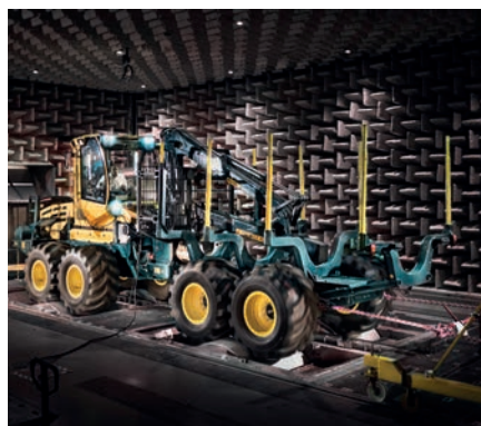
Forwarder (Tragrückenschlepper zum Einsatz in der Holzernte) auf dem Allrad-Akustik-Rollenprüfstand
