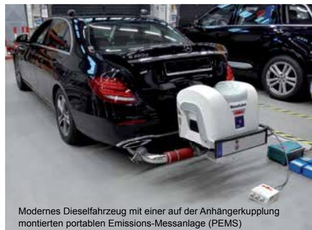
Modernes Dieselfahrzeug mit einer auf der Anhängerkupplung montierten portablen Emissions-Messanlage (PEMS)
