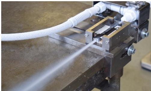
Kühlung mit flüssigem Stickstoff bei der Zerspanung von Titan
