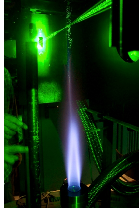
Laser-Diagnostik an einer Erdgasflamme, Quelle: ITT
