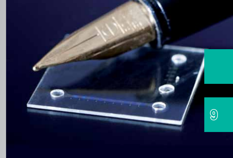
Ultraflacher Flüssigkeitsfarbstofflaser als Einwegchip von 1/3 Millimeter Dicke. In eine Polymerfolie wird mit Verfahren der Massenfertigung eine Kombination aus Nano- und Mikrostrukturen eingebracht. Sie ermöglicht frei wählbare Wellenlängen der integrierten Laser. Ein Team des Instituts für Mikrostrukturtechnik und der Danmarks Tekniske Universitet (DTU) entwickelte den Chip. Gemeinsam mit dem Institut für Angewandte und Numerische Mathematik perfektionierte das Team den Chip und veröffentlichte die Ergebnisse in zwei referierten Zeitschriftenbeiträgen.
