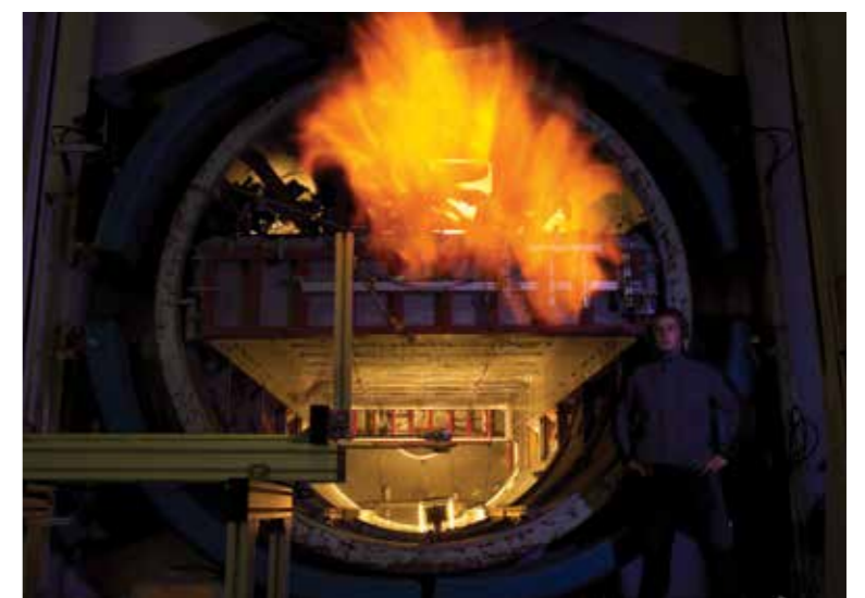
Experimente mit leicht flüchtigem Gas: Die robuste Druckkammer ermöglicht unterschiedliche Objekte, die mit Wasserstoff gefüllt sind, kontrolliert detonieren zu lassen. Foto: Volker Steger/KIT
