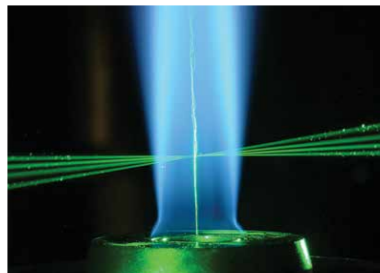
Raman-Spektroskopie in einer Erdgasflamme mit Tropfeneindüsung, Institut für Technische Thermodynamik
