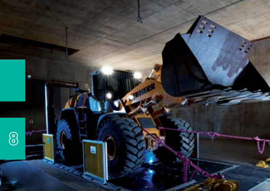
Radlader auf dem Akustikallradrollenprüfstand des Instituts für Fahrzeugsystemtechnik am KIT Campus Ost
