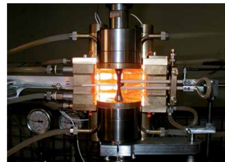
Test von Hochleistungswerkstoffen für Gasturbinen im Labor, Institut für Angewandte Materialien – Werkstoffkunde
